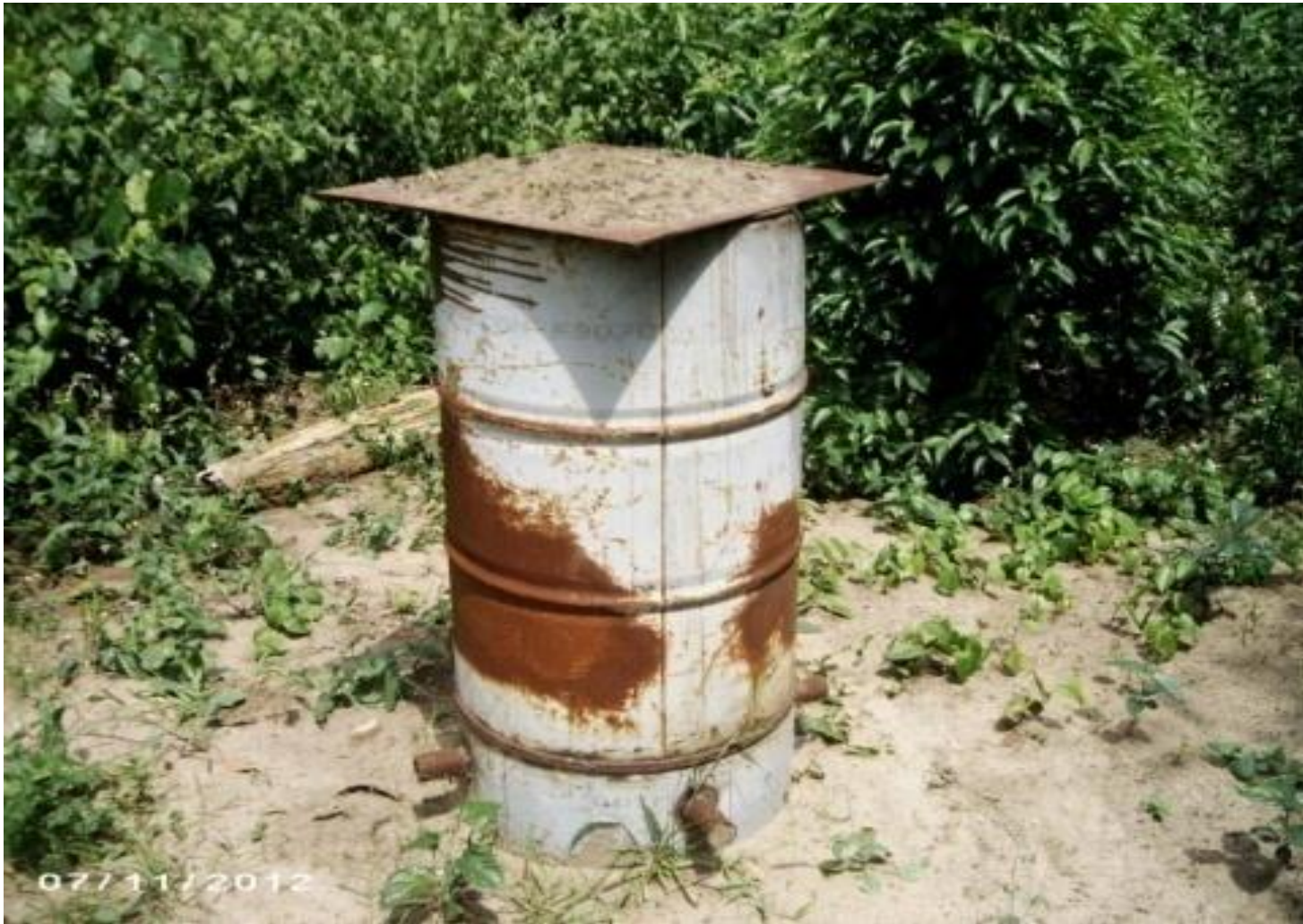
Fût de 200 l utilisé en four de carbonisation (Ahoba et Coulibaly, 2012)
